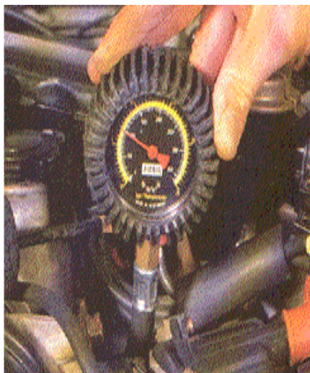
Kompresiometri për matjen e kompresionit në cilindër të motorit
